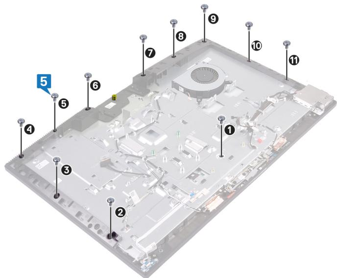
6 拧下显示屏面板上的夹具螺钉。
